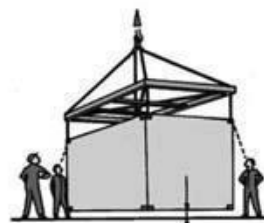
Comprobación de los datos adjuntos cuando el contenedor está todavía en el suelo
