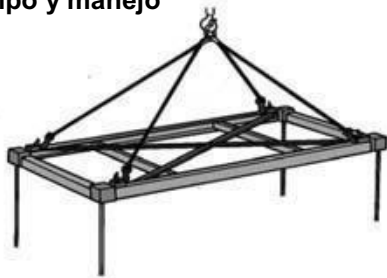
Ejemplo de elevación de contenedores usando una viga de elevación instaladas con ganchos, grilletes o manualmente bloqueada.
