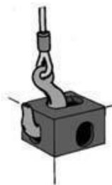
Ejemplo del agarre del gancho de seguridad con el gancho
