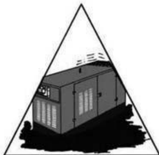
Cimiento demasiado desnivelado o blando.
